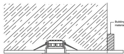
*Recouvrable par isolant soufflé/ déroulé*
