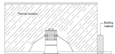
Recouvrable par isolant soufflé/ déroulé
