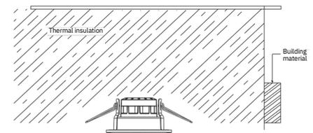
Recouvrable par isolant soufflé/ déroulé
